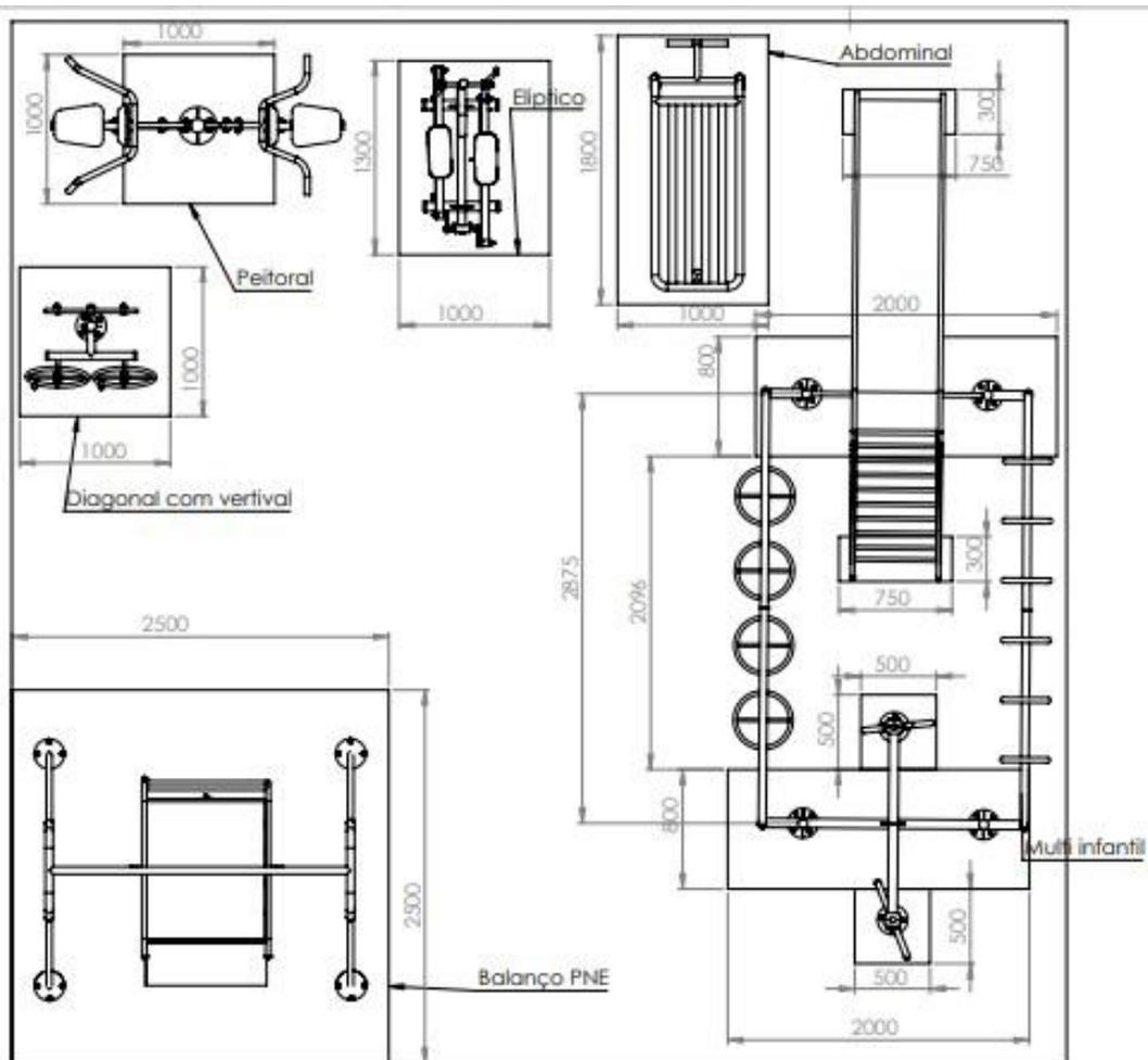
Figura 1 - detalhamento das bases em concreto armado
