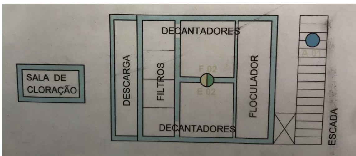
Figura 12. Disposição dos processos na ETA III.
